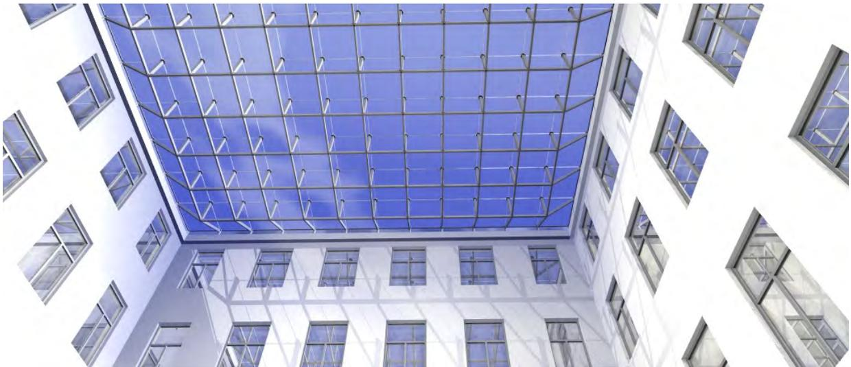
Abb. C 1-2: Bild aus der 3-D-Simulation für die Dachkonstruktion Halb-Vierendeel
