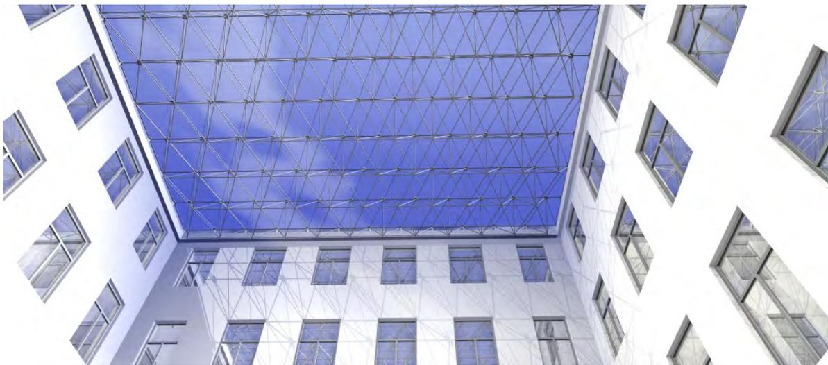
Abb. C 1-4: Bild aus der 3-D-Simulation für die Dachkonstruktion Oktaeder und Tetraeder
